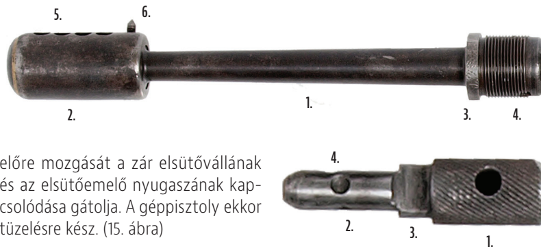
9. ÁBRA. A zárfogantyú részei: 1. zárfogantyú, 2. zármozgatócsap, 3. lapoltnyak/biztosító, 4. rögzítőfészek (A szerző szerkesztése a HTM, Modern Lőfegyver Gyűjtemény [Itsz.: 0009/Pu] tárgyának részletéről, Szikits Péter által készített fotó felhasználásával)
