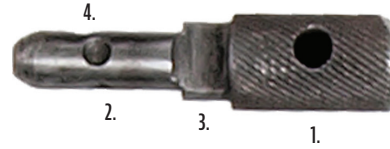
9. ÁBRA. A zárfogantyú részei: 1. zárfogantyú, 2. zármozgatócsap, 3. lapoltnyak/biztosító, 4. rögzítőfészek (A szerző szerkesztése a HTM, Modern Lőfegyver Gyűjtemény [Itsz.: 0009/Pu] tárgyának részletéről, Szikits Péter által készített fotó felhasználásával)
