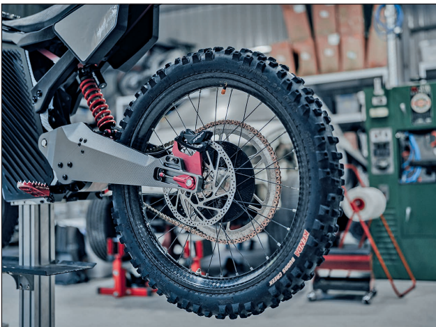
8. ábra. 3D-s nyomtatott titánalkatrészek a hajtásláncban, és szénszálás hátsókerék az amerikai Graft elektromos endurónál [23]
