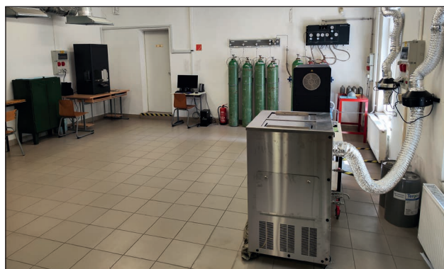
2. ábra. Az NKE Hadtudományi és Honvédtisztképző Karon kialakított 3D-s nyomtató laboratórium fémnyomtató terme ADAM-technológiájú nyomtatóval, mosóval és szinterező kemencével (Forrás: NKE HHK Haditechnikai Tanszék)
