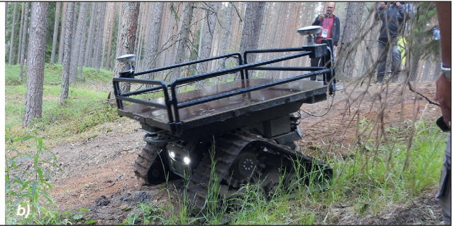
5. ábra. A DIEHL vállalat Ziesel vezető nélküli járműve „rácsodálkodik” a lejtőre a), majd legördül rajta b) (Fotók: Ocskay István)
