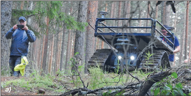
5. ábra. A DIEHL vállalat Ziesel vezető nélküli járműve „rácsodálkodik” a lejtőre a), majd legördül rajta b) (Fotók: Ocskay István)
