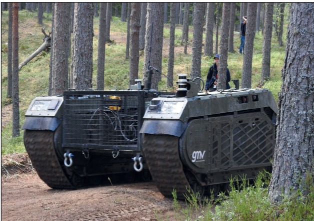
6. ábra. A MILREM Robotics vállalat THemis UGV-je MIFIK3 szenzorrendszerrel (Fotó: Ocskay István)
