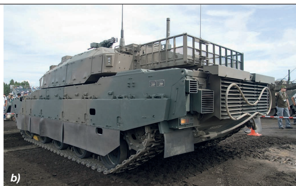
14. ábra. A Type10 kísérleti példánya a TK-X oldaldőlésben, szemlélve a hidropneumatikus felfüggesztést a). A futómű védelmét köténypáncél biztosítja b) [29]
