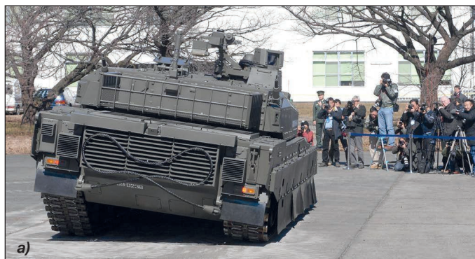
14. ábra. A Type10 kísérleti példánya a TK-X oldaldőlésben, szemlélve a hidropneumatikus felfüggesztést a). A futómű védelmét köténypáncél biztosítja b) [29]
