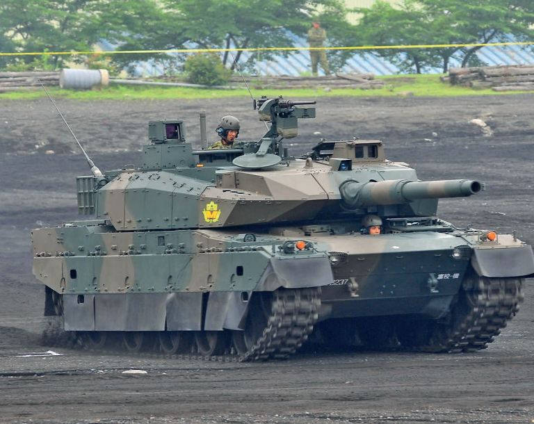
13. ábra. A Type 10 MBT lényegesen kisebb tömegű, mint más modern harckocsik. A TK-X tervezői nagy hangsúlyt fektettek a C4I képességekre, valamint a fokozott önvédelemre, a tűzerőre és a mozgékonyásra [28]
