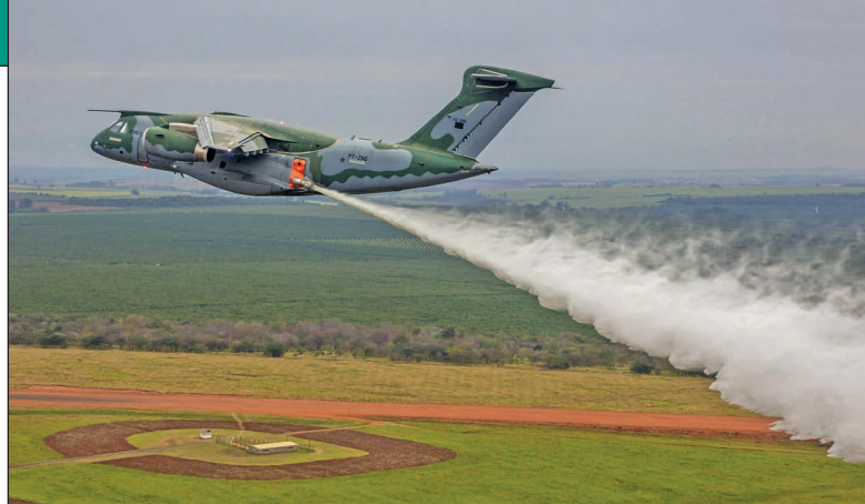
9. ábra. A KC-390 a MAFFS II tesztrepülése közben [16]
