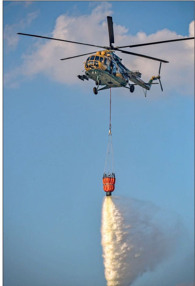
4. ábra. Egy Mil Mi-17-es helikopter Bambi Buckettel felszerelve (Fotó: HM Zrínyi Nkft. / Rácz Tünde)
