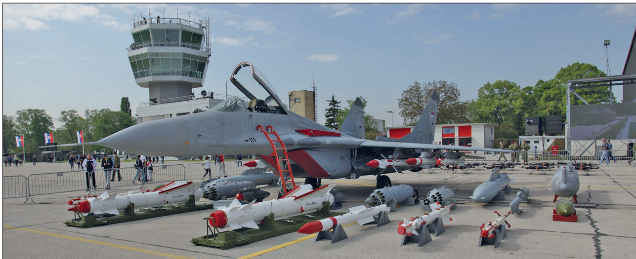
19. ábra. MiG-29SzM többfeladatu vadászipülőgép. Az avionika és a fegyverzetintegráció modernizálását a szerb MOMA, és orosz cégek közösen Batajnicán végezték (Fotó: Kelecsényi István)
