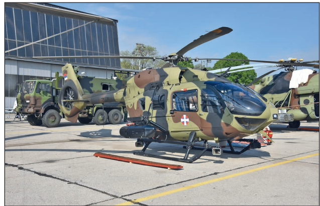
25. ábra. Szerbia is rendszeresítette az Airbus H-145M típusú könnyű többfeladatú helikoptert. A fegyverzetet maguk gyártják a típushoz. Az első beszerzésben a BK.117D2m négylapátos, a másodikban már a BK.117D3m öt forgószárny-lapátos változatot rendelték meg (Fotó: Kelecsényi István)
