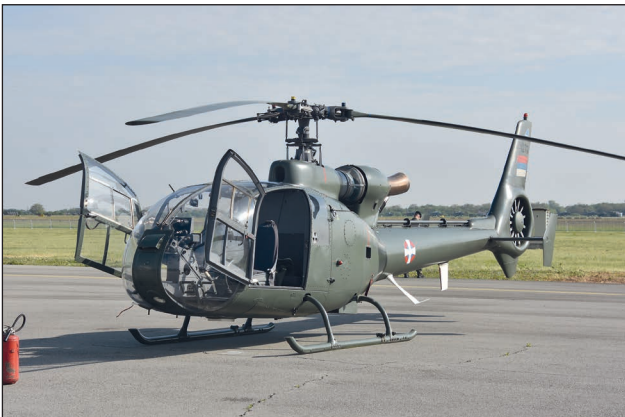
24. ábra. Soko HM-42M Gama könnyű páncéltörő helikopter. A Maljutka 2T5 (9M14П1-2T5 Мальютка) rakéták irányítórendszerét a pilótakabin tetejére szerelték (Fotó: Kelecsényi István)
