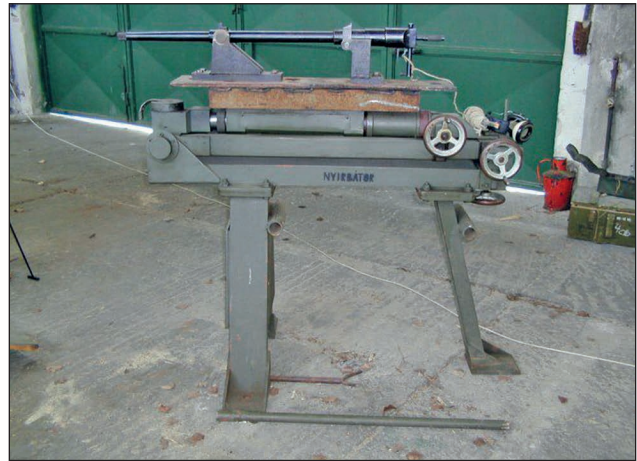
2. ábra. Sebességmérő ballisztikai cső az egységes belövőpad tetején. Az elsütőbillentyűre kötött zsinór kísérleti lövésekkor a távelsütés kötelező tartozéka
