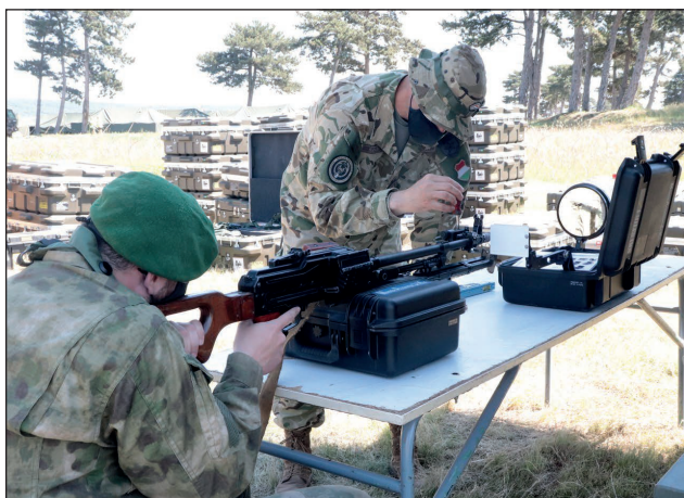
6. ábra. Tükrös beszabályzó készlet kézfegyverekhez. Az MH BHK Szimulációs (MILES) részleg technikusai a lézervető beszabályozásán dolgoznak (Fotó: MH BHK / Pintér László)
