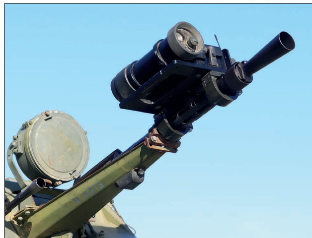
7. ábra. BTR-80 páncélozott szállító harcjármű KPVT géppuskára integrált lézervetővel (Fotó: MH BHK / Pintér László)
