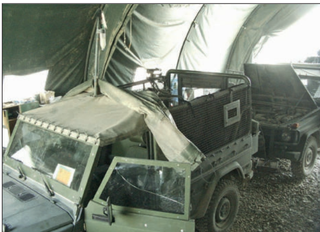
7. ábra. MB G-270 BA10 terepjárók felpáncélozása Kabulban, az MH Könnyű Gyalog Századnál (Fotó: Ocskay István)
