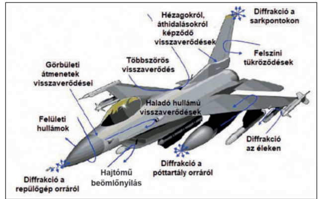
9. ábra. A radarimpulzus céltárgyról való visszaverődésének komplexitása [12]
