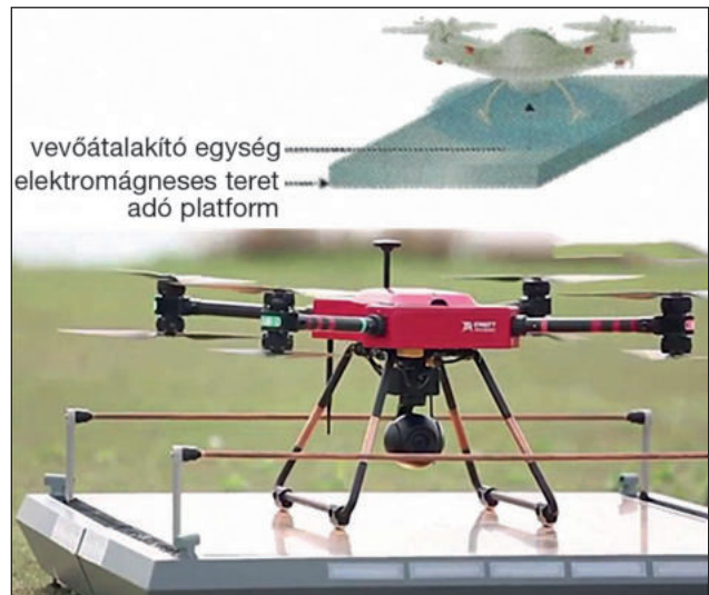
34. ábra. Dróntöltő indukciós platform (szerzői montázs a [4] alapján)
