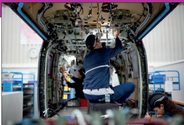
12. ábra. Belső szerelési munkák az Airbus H145-ös helikopter kompozit törzsében (Fotó: Airbus)
