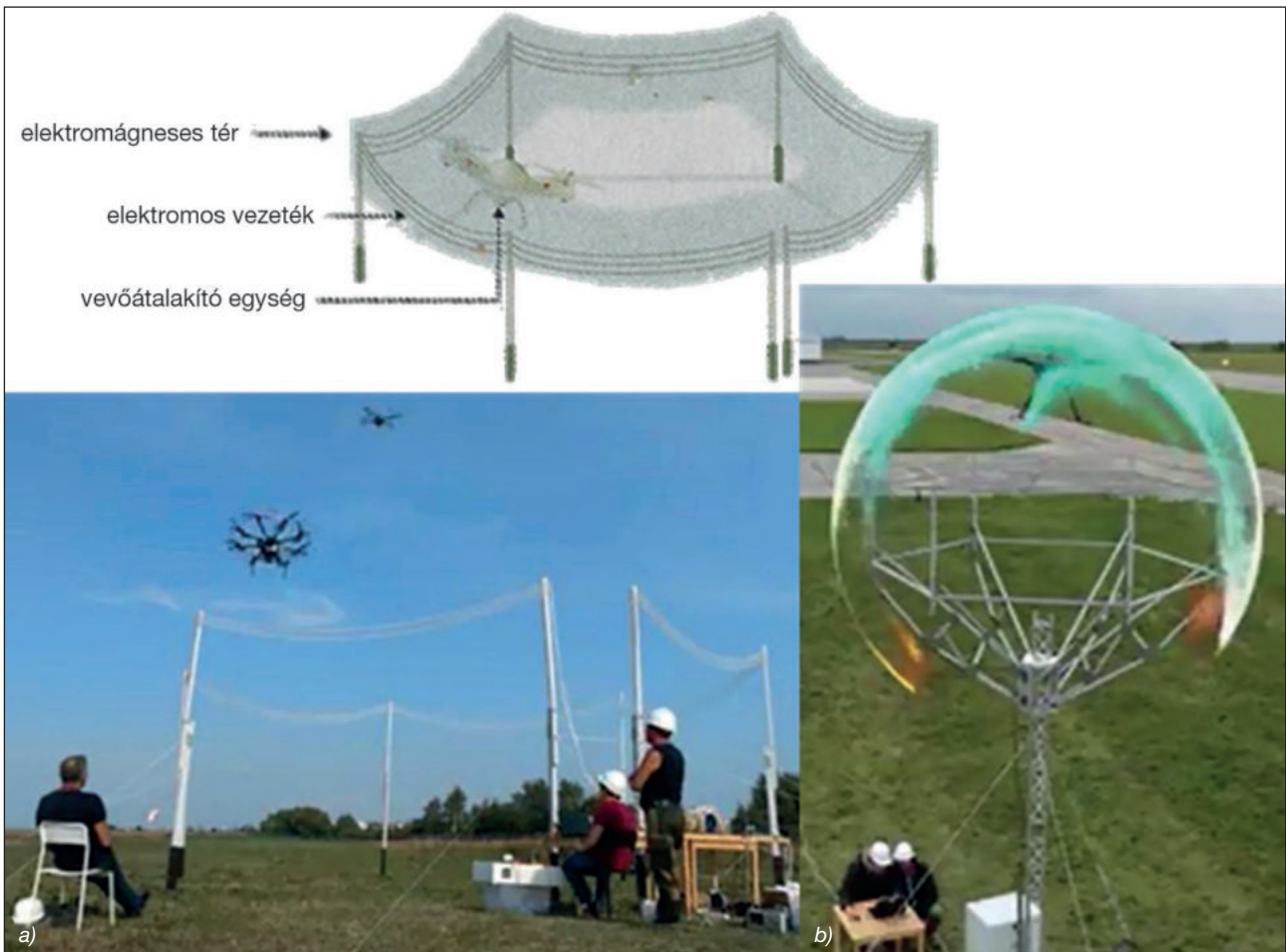
33. ábra. Dróntöltő indukciós hexaéderrács (szerzői montázs gyári videók és a [3] alapján)
