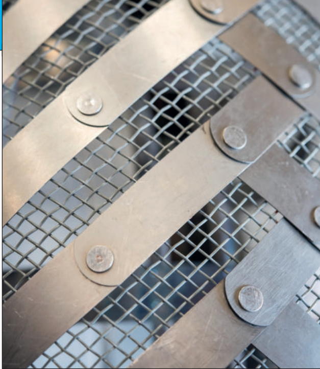
9. ábra. A holdautó Pavlics Ferenc szabadalma alapján készített kerekének részlete. A zongorahúrokból szőtt hálót szegecsekkel felerősített titánszalagokkal vették körül. A megoldás nemcsak kellő rugalmasságot biztosított, hanem a kerék kipörgését is megakadályozta a poros talajon [19]
