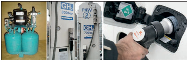
40. ábra. Hidrogénfejlesztő és -töltő berendezések [9]
