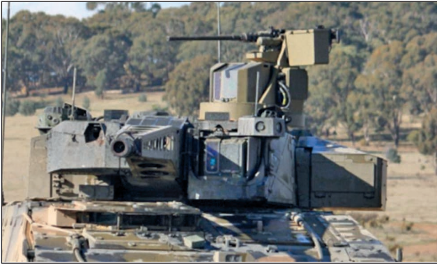
27. ábra. Egy ausztrál Boxer CRV kerekos felderítő harcjármű Lance 1.0 tornyán lévő MSSA fegyverállvány, M2, 12,7 mm-es géppuskával szerelve [24]
