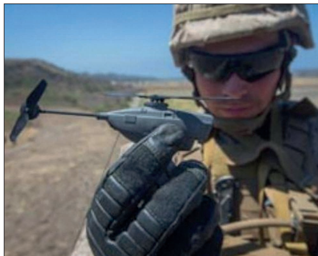
22. ábra. Egyforgószárnyas, faroklégcsvaros drón (Fotó: Pintereset)
