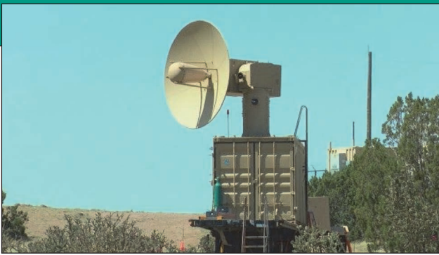
4. ábra. Az USAF által üzemeltetett mikrohullámú THOR rendszer, „konténeres” telepítésben [7]
