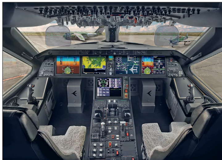
7. ábra. A pilótafülkét a XXI. századi követelményeket kielégítő berendezésekkel, fly-by-wire kormányrendszerrel, digitális szemmagasságú kijelzővel szerelték fel. A műszerek alkalmasak éjjellátó szemüveg használata közben végzett repülésekre is (Fotó: Embraer Defense and Security)
