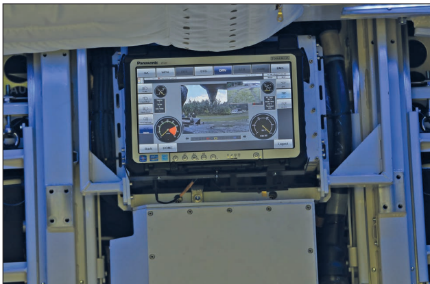
30. ábra. A harcjármű küzdőterében, a toronyoszorú védőrácsára felhelyezett nagyméretű digitális képernyő [18]
