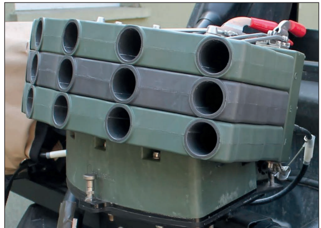
31. ábra. A Lance 1.0 toronynál alkalmazott ROSY ködgránátvető csövek kötege (Fotó: Rheinmetall AG)
