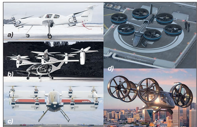
27. ábra. Néhány eVTOL szerkezeti kialakítás elfordítható toló/vonólégszavarral
