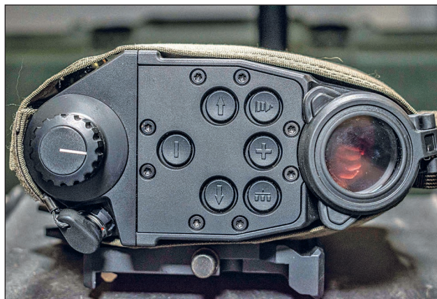
9. ábra. Az FCS13RE miniaturizált tűzvezető rendszer a Carl-Gustaf M4 fejeven (Fotó: Merckle Bálint)
