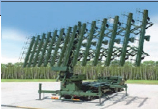
9. ábra. Lengyel fejlesztésű, nagy teljesítményű VHF-rádiólokátor
