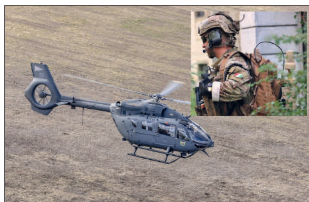
1. ábra. A Magyar Honvédség legkorszerűbb műholdas rádiórendszerei. A helikopter faroktartójának jobb oldalán a vezérsík előtt látható az UHF TACSAT rendszer antennája, a jobb oldali oldalajtó felett pedig az L-TAC/SlingShot rendszer antennája. A betétképen a különleges műveleti katoná felszerelésére rögzítve látható az L-TAC/SlingShot antenna (Forrás: honvedelem.hu és különlegesdandár.hu)
