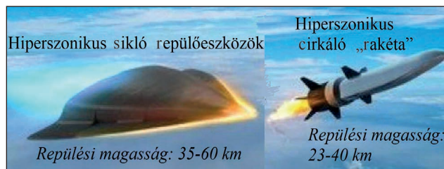
2. ábra. A hiperszonikus repülőeszközök két fő típusának fizikai kialakítása
