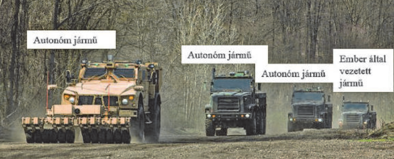
15. ábra. TerraMax rendszer alkalmazása logisztikai feladatot ellátó menetoszlopban [17]
