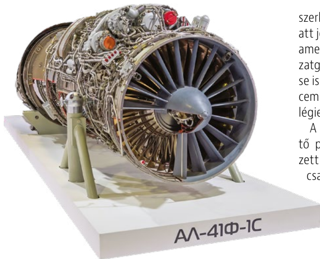
4. ÁBRA. A Szu-57 vadászpilóta nélküli repülőgéppel kapcsolatos AL-41F1 típusú tolóerővektoros hajtóműve (Forrás: Shutterstock)
