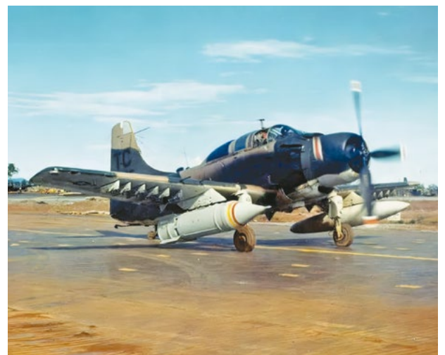
2. ÁBRA. Az amerikai légierő Douglas A-1E Skyraider repülőgépe egy BLU-72/B típusú bombát szállít a jobb szárnya alatt, 1968. szeptember 29. [11]
