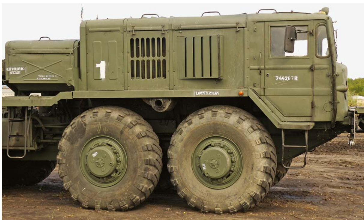
3. ÁBRA. A MAZ-537G vezetőfülkéje, mögötte a motorház, leghátul a csörlőház látható (Forrás: Varga A. / Wikimedia)
