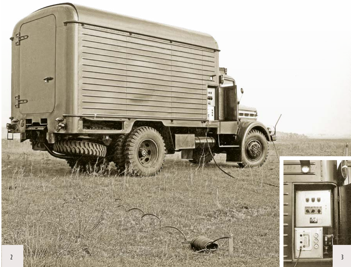
2. ÁBRA. Generátorüzemben telepített hűtőgépkocsi nyitott csatlakozótérrel; az előtérben a segédföldelő nyárs látható [1]
