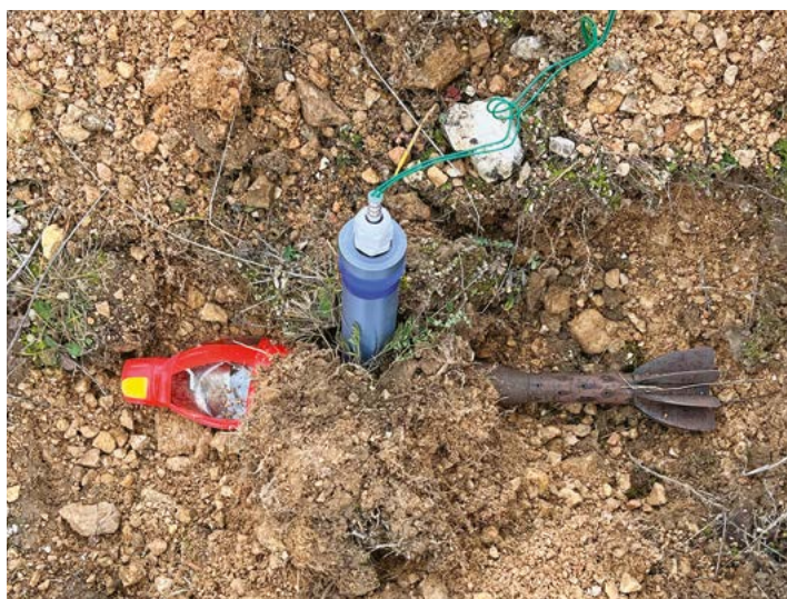
10. ÁBRA. Kumulatív töltet részleges gyújtószerkezettel rendelkező, 60 mm-es aknavetőgránáton (balra); jobb oldalon a teljesen megsemmisült gránát helye látható (Fotók: Bokros Tünde Ibolya)
