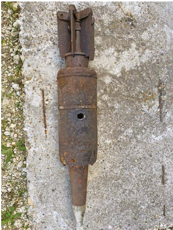
8. ÁBRA. Az inert BK-14M HEAT lövedék falának egyoldali lyukasztása és vágása kumulatív töltet által (Fotók: Kugyela Lóránd)
