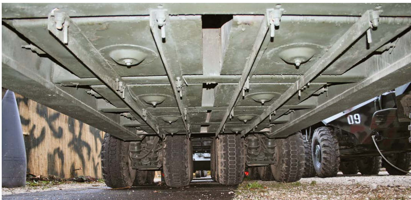
5. ÁBRA. A CsMZAP-9990 típusú félpótkocsi tartaléktüzelőanyag-tartalycsoportjai alulnézetből (Forrás: Fodor Gábor)
