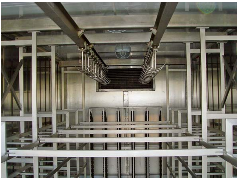
13. ÁBRA. Polcrendszer a hűtőakkumulátorok számára és a sín pályák a horgokkal [3]
