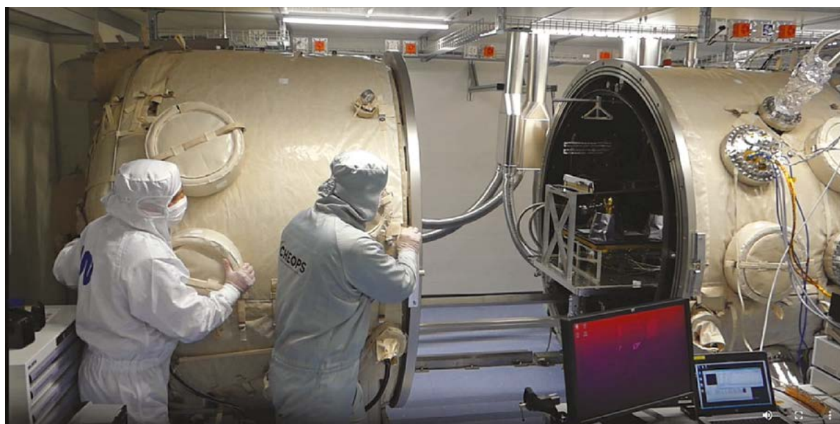
11. ÁBRA. Az integrált PEP-Lo-egység hő-vákuum tesztje (-170 °C – +60 °C) a Berni Egyetemen. A PEP egységeit – néhány érzékeny alkatrész miatt – a beépített fűtőelemek -50 °C alá nem engedik hűlni a JUICE űrszondán (Fotó: UBE)
