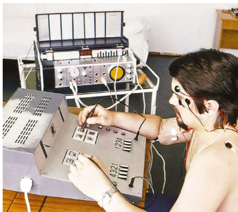
8. ÁBRA. A percepció műszer képes volt a négyválasztásos reakcióidő mérésére (A szerző felvétele)
