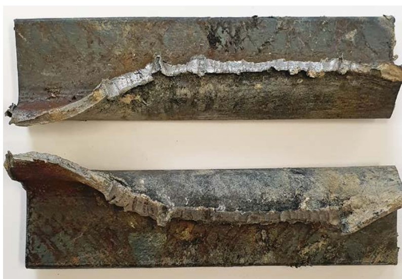
6. ÁBRA. A vágótöltet hatása a céltárgyon (A szerzők felvétele)
