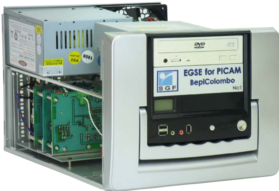
8. ÁBRA. A PICAM bemérését szolgáló jelszintű szimulátor (Fotó: SGF Kft.)
