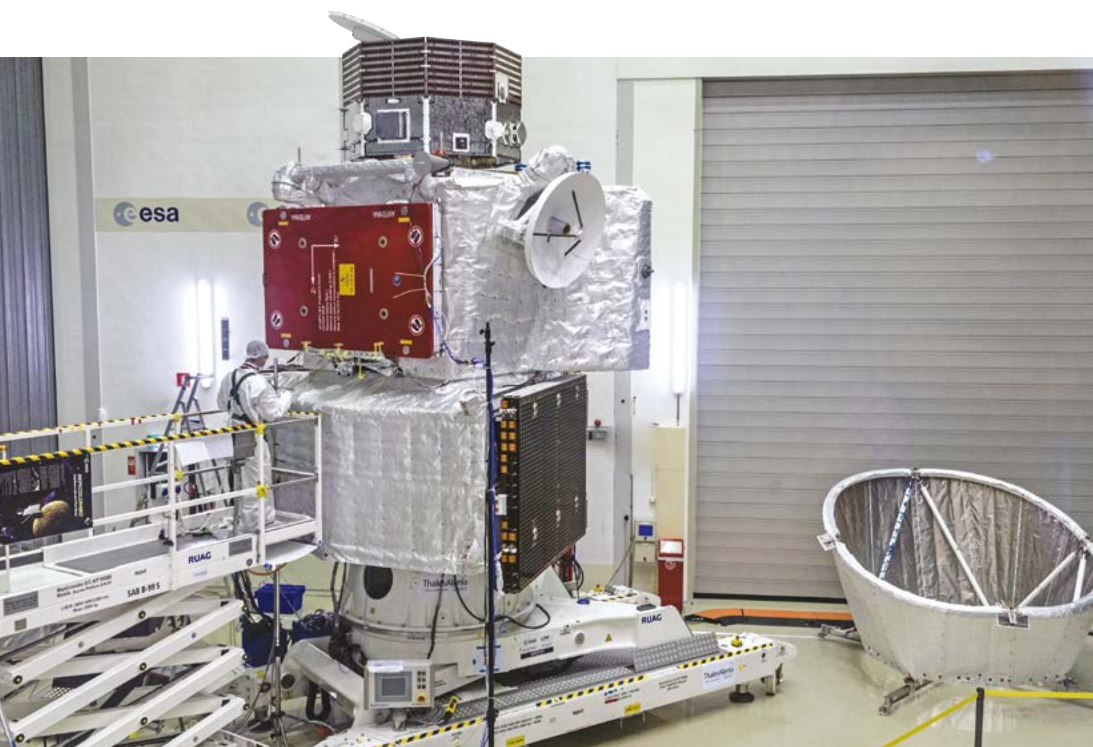
2. ÁBRA. BepiColombo űrszonda összeszerelés közben. Alul látható az MTM, felette az MPO, legfelül az MMO és jobbra lent a hővédő MOSIF (Fotó: ESA)
