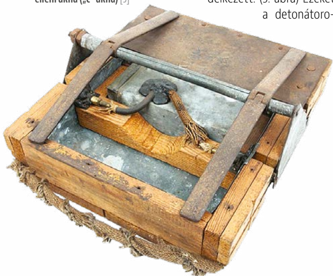
5. ÁBRA. Német Flachmine 17 harckocsi elleni akna („C” akna) [9]
