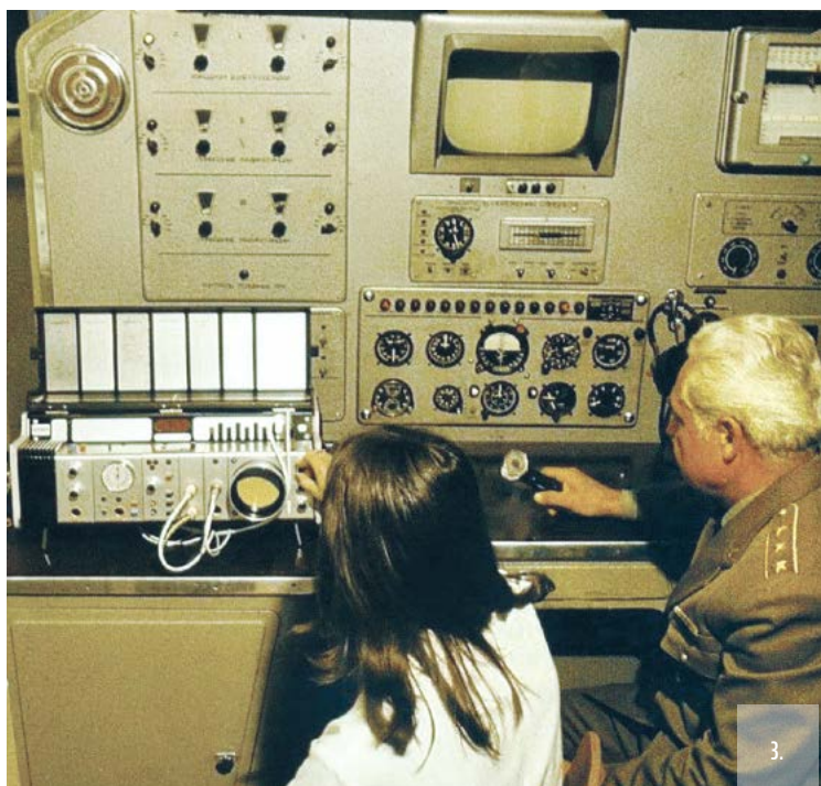
3. ÁBRA. A ROVKI Repülő Gyakorló Állomás MIG-21-es (TL-8 típusú) repülőgép-szimulátorán KTD-1 készülékkel repülés közben mérték a pilóták vérnyomását és pulzusszámát (A szerző felvétele)
