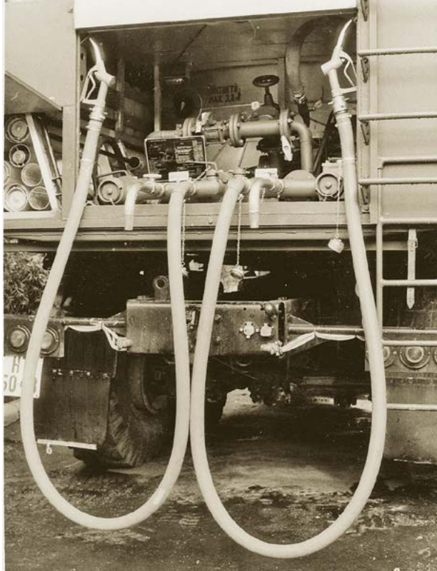
5. ÁBRA. A hátsó töltő- és kiszolgálóter nyitott állapotban (Fotó: Haditechnika archív)
