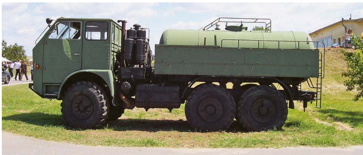
4. ÁBRA. DAC-665T alváza épített vízszállító gépkocsi [8]
