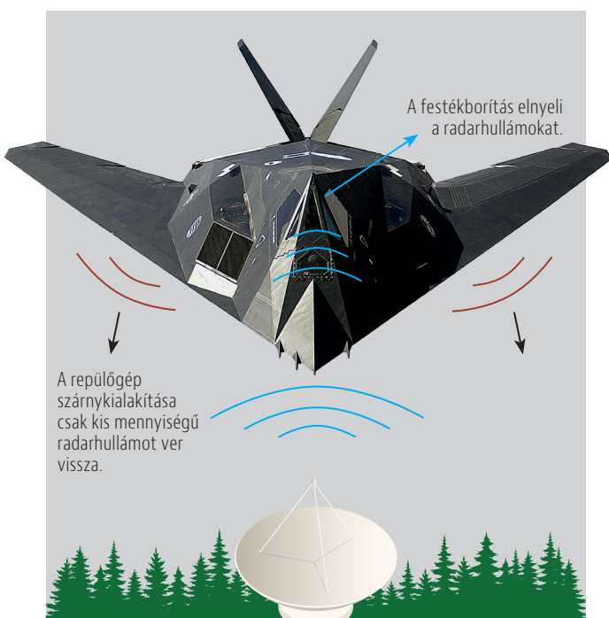
1. ÁBRA. A lopakodó technológia alkalmazása a Lockheed F-117A Nighthawk repülőgépen (A szerzők szerkesztése)
