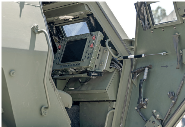
2. ÁBRA. Az irányzó munkahelye a tüzevető számítógép kezelőegységével (Forrás: Shutterstock)
