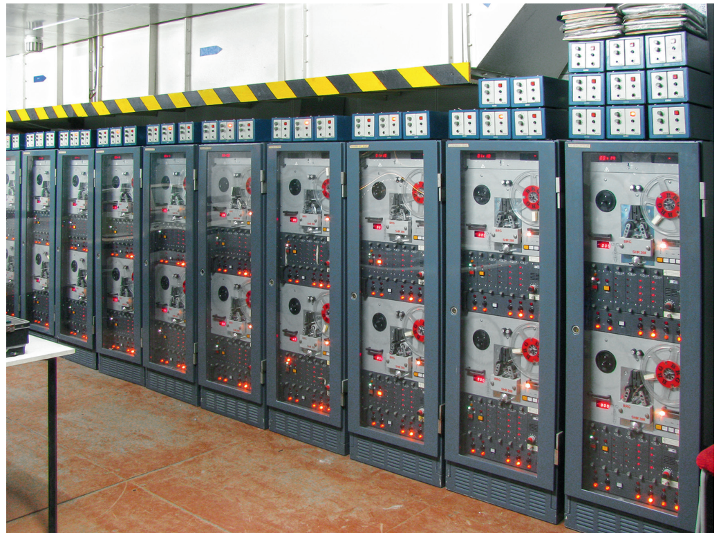
6. ÁBRA. A magyar BRG (Budapesti Rádiótechnikai Gyar) által készített SHR-208 típusú mágnesszalagos jel- és hangrögzítők berendezések szekrényei a 41. légvédelmi rakétadandár ladeburgi harcálláspontján Berlintől északra (A szerző felvétele)
