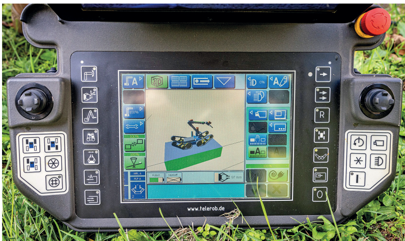
3. ÁBRA. A tűzserézsrobot irányítópanelje (Fotó: MH 1. TFE)
