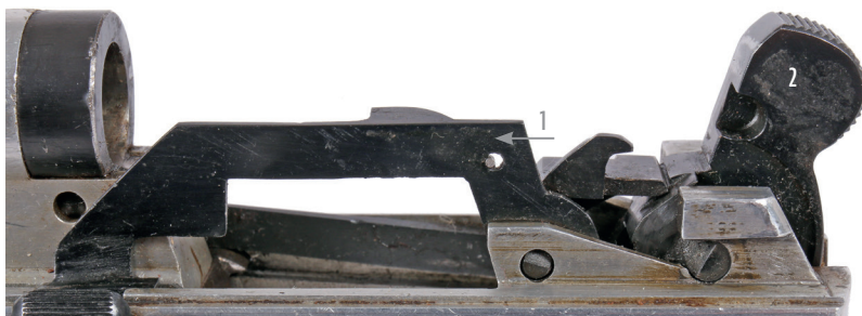
10. ÁBRA. Az M-9 pisztoly elsütőszerkezete biztosításkor (A szerző szerkesztése, Szikits Péter felvételének felhasználásával) [1]
