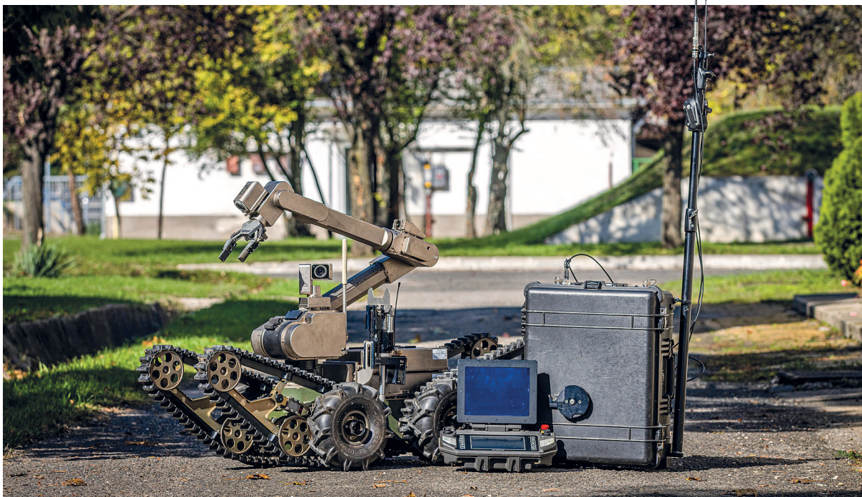
5. ÁBRA. A Telex PRO V4.0 típusú könnyű tüzsereszrobot a kiegészítő egységeivel (Fotó: MH 1. TFE)
