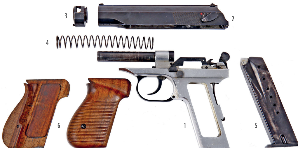
4. ÁBRA. Az M-9 pisztoly fő részei. 1. tok a csővel, a markolattal, az elsütőszerkezettel, a vezetőhornyokkal és a sátorvassal; 2. szán a célgömbbel, a nézőkével, az ütőszeggel, a biztosítóval, a vezetőléccel és a kivetőnyílással; 3. kompenzátor a bajonettzárallal; 4. helyretelő rugó; 5. tölténytár az adogatógömbbel, az adogatórugóval, a tárfenékkel és rögzítőjével; 6. markolathej (jobb, bal) (A szerző szerkesztése, Szikits Péter felvételének felhasználásával) [1]
