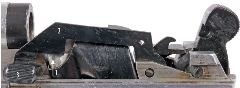
9. ÁBRA. Az M-9 pisztoly szánrögzítő működése (A szerző szerkesztése, Szikits Péter felvételének felhasználásával) [1]
