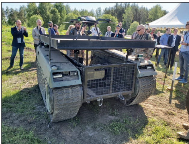
2. ábra. Egy megfigyelődrónnal felszerelt THeMIS láncaltpas UGV a tapai bemutatón, Észtországban (Fotó: Ocskay István)
