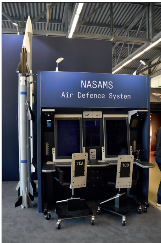
3. ábra. A norvég Kongsberg és az amerikai Raytheon cégek által fejlesztett NASAMS légvédelmi rendszer tűzelosztó központ (FDC) makettjét is megtekinthették az érdeklődők. A képen bal oldalon a rendszerrel jelenleg együttműködni képes rakéták, az AMRAAM, az AMRAAM-ER és az AIM-9X Sidewinder láthatók (Fotó: Kelecsényi István)
