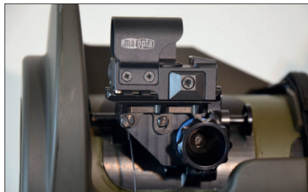
6. ábra. A CGM4 fegyverrendszer vöröspontos (másodlagos) irányzéka (Fotó: Birinyi János)
