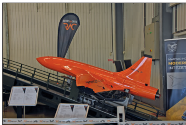
6. ábra. A veresegyházi székhelyű Rotors & Cams Zrt. PROTAR típusú gázturbinás, katapultos indítású célrepülőgép (Fotó: Kelecsényi István)
