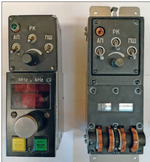
6. ábra. A 7a,6 kezelőegység a hangolóegységgel (Fotó: Domán László)
