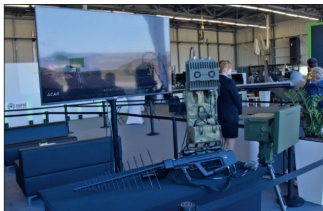
4. ábra. A török Aselsan cégcsoport IHASAVAR típusú drónelhárító kézi eszközrendszer. A hordozható eszköz nagy kapacitású Li-Ion akkumulátorokkal működik, és egy feltöltéssel 1,5 órán keresztül képes üzemelni. A török vállalat szerint az eszközre több mint 100 zavarási profil programozható (Fotó: Kelecsényi István)
