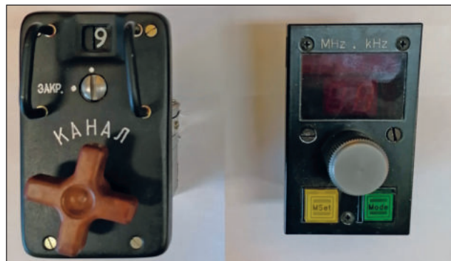
3. ábra. A 19-1a 3Y (ZU) mechanikus (bal oldalon) és ZU-M elektronikus hangolóblokkok (jobb oldalon) (Fotó: Domán László)
